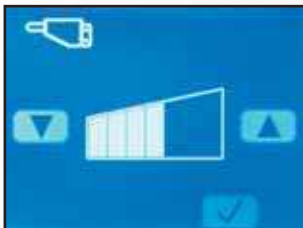
Fein-Einstellung des Hydraulikölstroms in der Hammer-Betriebsart (B)
