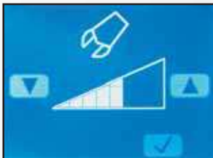
Fein-Einstellung des Hydraulikölstroms in der Power-Betriebsart (P) oder Economy-Betriebsart (E)
