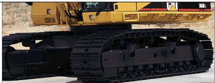
**Fahrmotoren.** Zweistufige Fahrmotoren mit automatischer Umschaltung verhelfen dem 365B-II L zu maximaler Geschwindigkeit beim Standortwechsel beziehungsweise höchster Zugkraft an Steigungen und beim Wenden. Bremsventile verhindern ein Überdrehen der Motoren am Gefälle und spezielle Sekundär-Druckbegrenzungsventile sorgen für weiche Bremsvorgänge.
